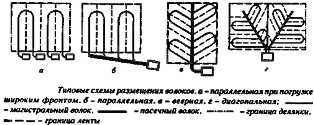
Рис.1 Типовые схемы размещения волоков
