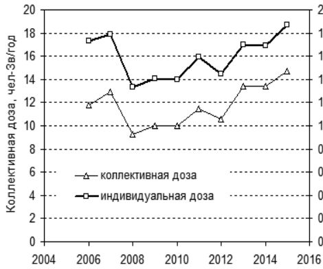
Рис. 8.4. – Годовая коллективная и средняя индивидуальная дозы персонала группы А на предприятиях, использующих ИИИ, в 2006–2015 годах
