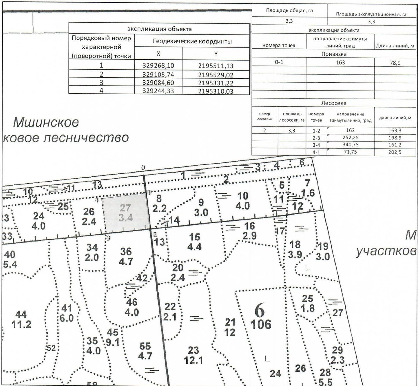
Геодезические координаты получены при помощи stonex s800a в системе координат МСК 47 зона 2
